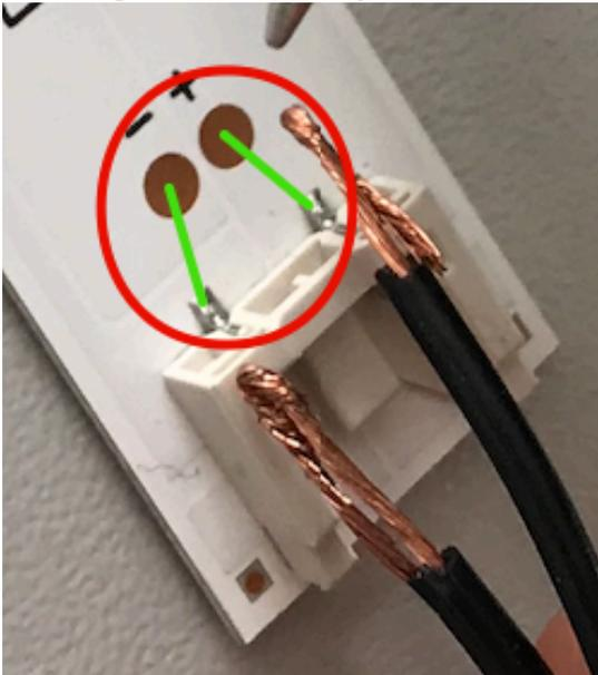
2. Falls Durchgang vorhanden das Kabel direkt an die Messpunkte löten. Andernfalls an die Pins vom Connector löten.
